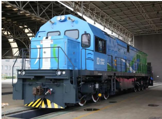
机车辅机传动均采用交流变频控制技术，进一步降低机车辅助功率消耗；采用永磁牵引技术，永磁牵引电机完美契合了调车机车频繁起停以及低速工况多的特点，传动效率较交流异步电机效率提高 10%以上；采用了混合制动，在不改变司机操作习惯的前提下，优先实施回馈制动，最大程度回收制动能量。
