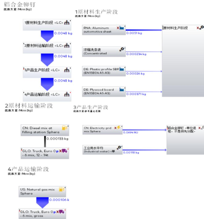
图 5.1 生产 1 件 6mm 铝合金单槽铆钉产品生命周期评价 GaBi 总模型
